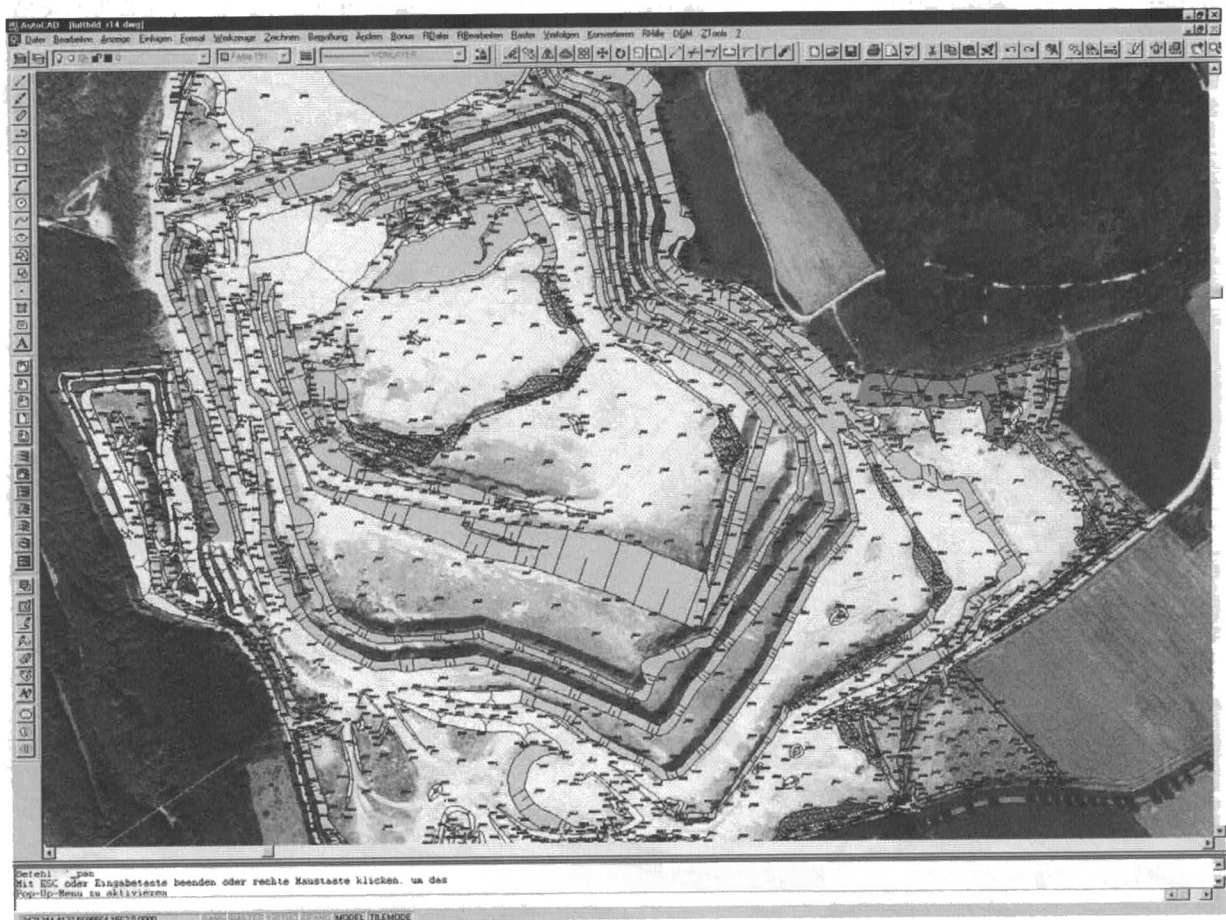
Abb. 2: Aerophotogrammetrische Auswertung eines Gewinnungsrisses mit Luftbildhinterlegung.
